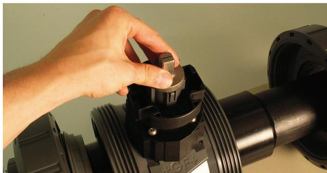
2 Stecken Sie den Zapfen durch die Öffnung des Gehäuses. Hinweis: Achten Sie darauf, den Zapfen in der richtigen Position einzustecken. Beachten Sie hierzu die Kontur des Zapfens und des Kugelhahns.
