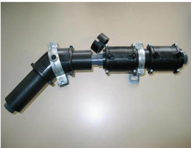
Fitting wird zuerst an der Innenrohrleitung mit dem vorbereiteten Doppelrohrstück verbunden (Schweissen oder Kleben), bevor nach einer Druckprobe der Innenrohrleitung das Aussenrohr mit eingelegtem Schnappring durch die Elektro-Schweissmuffe druckfest verbunden wird.
