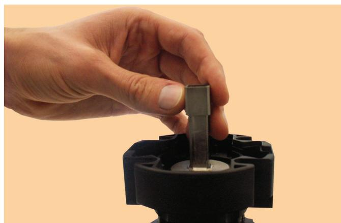
5 Setzen Sie die Reduzierhülse auf den Zapfen des Kugelhahns.
