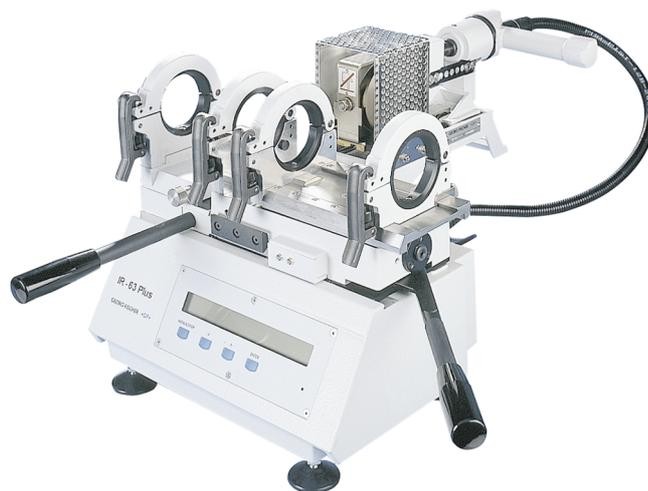
Beim IR-Schweissen werden die zu verbindenden Teile (Rohr und Fitting) im Schweissbereich auf Schweisstemperatur berührungslos erwärmt und verschweisst. Dieses spannungsarme Schweissverfahren ermöglicht kleinere Schweisswülste.
