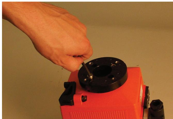
4 Montieren Sie die Adapterplatte mit vier Senkschrauben an den Antrieb.
