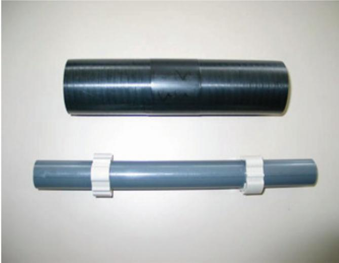
Aussenrohr (schwarz, geschälte und gereinigte Schweissflächen) hat gegenüber dem Innenrohr (grau, mit aufgeklebten Distanzhaltern) ein unterschiedliches Längenmass.
