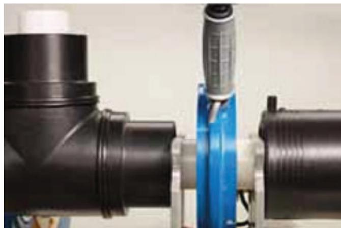
Alle Verbindungen müssen bei Druckrohren in der Stumpfschweissmaschine und nicht von Hand hergestellt werden.
