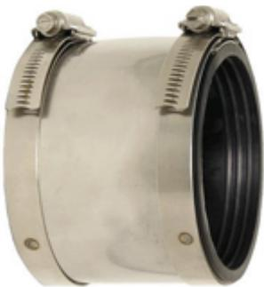
Die EPDM Gummimanschette ist druckfest bis 1 bar. Mit der EPDM Gummimanschette können die von +GF+ angebotenen Materialien PE100 und transparentes PVC-U der Aussenleitung schnell, werkzeuglos und ohne Aussenleitung miteinander verbunden werden. Die Verbindung der Fittings ist gleich wie beim druckfesten System. Für die Aussenleitung wird vorzugsweise transparentes PVC-U verwendet.
