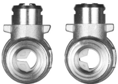
Kv_S = 2,5 \text{ m}^3/\text{h} Kv_S = 4 \text{ m}^3/\text{h} 2 VIE ATTACCO MASCHIO-MASCHIO PASSAGGIO TOTALE CON DISCHETTO DI REGOLAZIONE Ø 1/2"
