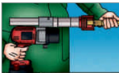
4 - Premere l'interruttore di avanzamento fino alla completa formazione del bicchiere (lo sganciamento del tubo avverrà automaticamente).
