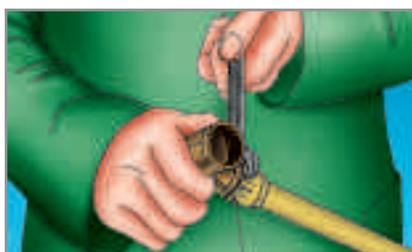
6 - Avvitare la calotta fino alla dentellatura di sicurezza antisvitamento (utilizzare l'apposita chiave fissa serie 50600).
