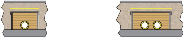
**Fig. 6 - Tubazioni interrate posti in apposita struttura**
